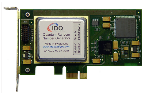
A svájci ID Quantique cég kvantum alapokon működő véletlenszám-generátorát akár a képen látható módon kártyaként helyezhetjük egy számítógép belsejébe, akár egy USB-porton keresztül csatlakoztathatjuk laptopunkhoz (Forrás: ID Quantique)
