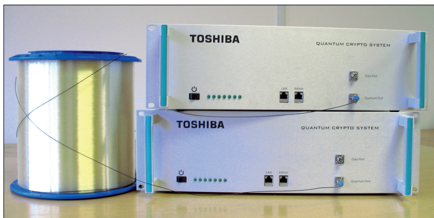
2008-ban Ausztriában, a gyakorlatban is demonstrálták egy kvantum alapú kulcsszétosztó hálózat működését, összekötve négy bécsi és egy St. Pölten-i csomópontot. Az ábrán látható két doboz a két kommunikáló fél (Aliz és Bob), amelyet optikai szállal kapcsolnak egymáshoz (Forrás: SECOQC projekt)
