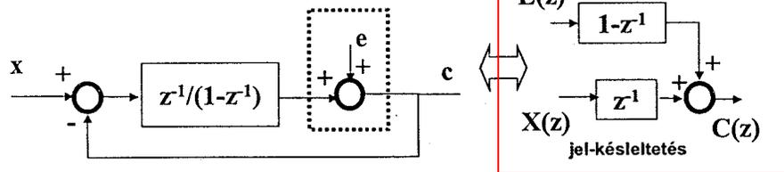
A jel és kvantálási-zaj spektrum szeparálódik (!), a keskenysávú jelre a transzfer függvény:  $z^{-1}$  (ez csak késleltetés), míg a szélesávú zajt formáló transzfer függvény:  $1 - z^{-1}$  (ez diszkrét idejű elsőrendű differenciáló  $\rightarrow$  frekvencia szelektív: nagyfrekvenciás kiemelő, felüláteresztő szűrő)
