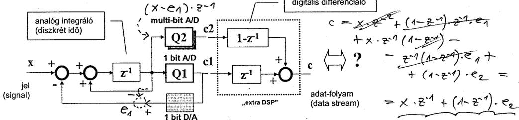
(b) Egy trükk a probléma megoldására: 1-0 MASH két kvantálós architektúra [T. Leslie, B. Singh 1990]; a hatásos kvantáló (Q2) felbontása és a visszacsatolás (Q1) felbontása szétválik („multi-bites” kvantálás *kontra* „1 bites” visszacsatolás). Adjuk meg az ekvivalens topológiát (linearizált kvantáló modellek, hibamentes 1 bites D/A).
