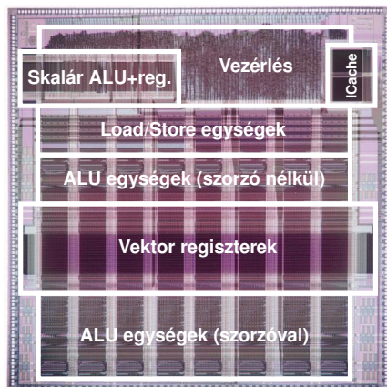
19.2. ábra. A T0 vektorprocesszor felépítése
