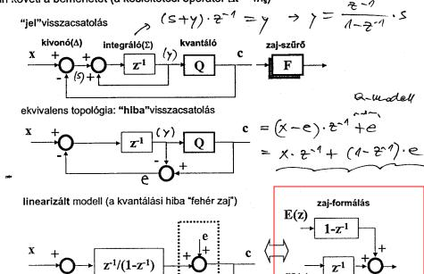
A <u>jel</u> és <u>kvantálási-zaj</u> spektrum <u>szeparálódik</u> (!), a keskenysávú *jelre* a transzfer függvény:  $z^{-1}$  (ez csak késleltetés), míg a szélessávú *zajt formáló* transzfer függvény: 1 -  $z^{-1}$  (ez diszkrét idejű **elsőrendű** differenciáló  $\rightarrow$  frekvencia szelektív: nagyfrekvenciás kiemelő, felüláteresztő szűrő)
