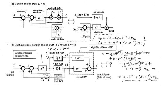
(b) Egy <u>trükk</u> a probléma megoldására: 1-0 MASH két kvantálós architektúra [T. Leslie, B. Singh 1990]; a hatásos kvantáló (Q2) felbontása és a visszacsatolás (Q1) felbontása szétválik ("multibites" kvantálás kontra "1 bites" visszacsatolás). Adjuk meg az ekvivalens topológiát (linearizált kvantáló modellek, hibamentes 1 bites D/A).
